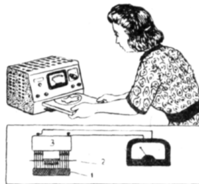
Прибор для измерения площадей: 1 — радиоактивный препарат (путь испускаемых частиц показан стрелками), 2 — измеряемая площадь, 3 — счетчик.
