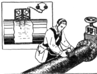
Действие переносного прибора для обнаружения коррозии труб.
